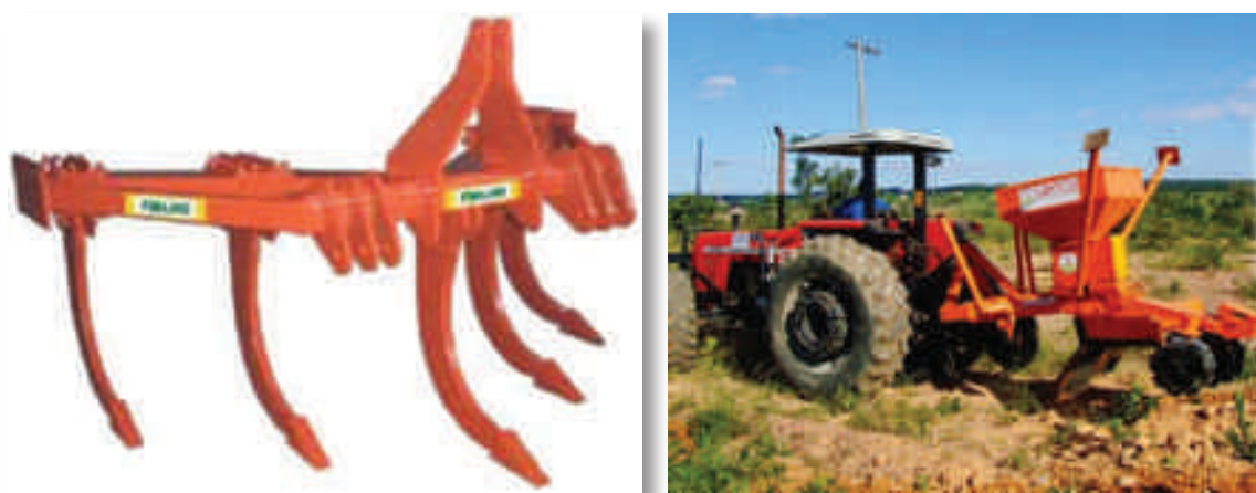
Figura 16 - Subsolador e Subsolador com aplicador de adubo
