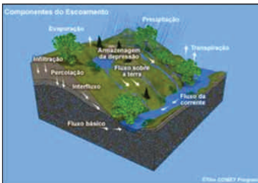
Figura 26 - Escoamento de águas superficiais
