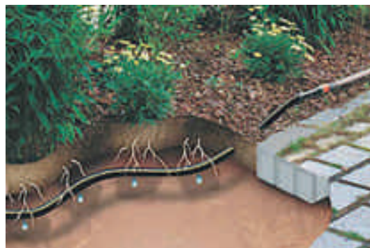
Figura 37 - Sistema de rega gota a gota
