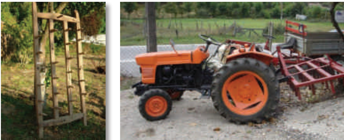
Figura 13 - grade de dentes em madeira e grade de dentes acoplada ao trator
