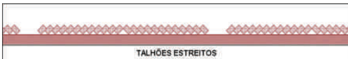
Figura 29 - Método de drenagem superficial por talhões estreitos
