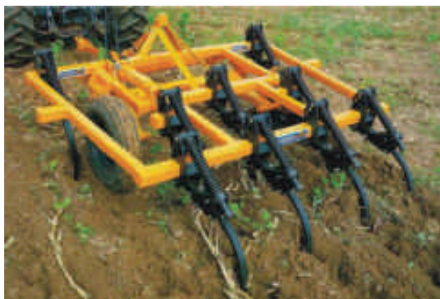
Figura 5 - Preparação mínima com escarificador pesado.
