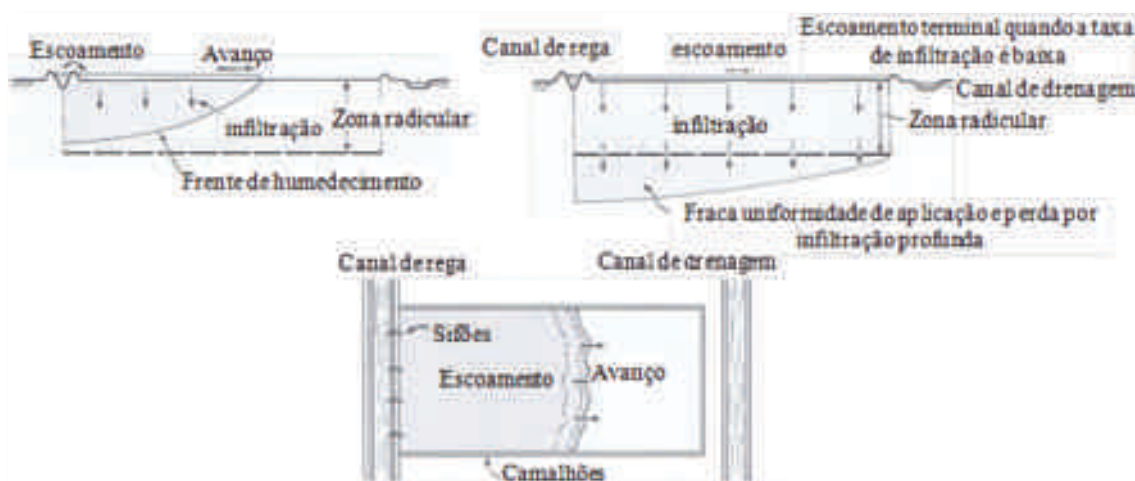
Figura 3 - Esquemática da rega por gravidade em planta (cima/esquerda), em perfil durante a fase de avanço (cima/direita) e no final da rega (baixo)
