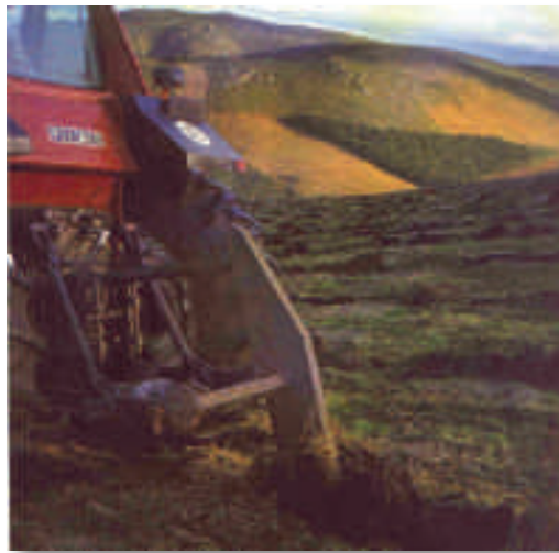
Figura 18 - Ripper de um dente
